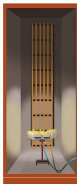
Šíření plamene ve svazcích
