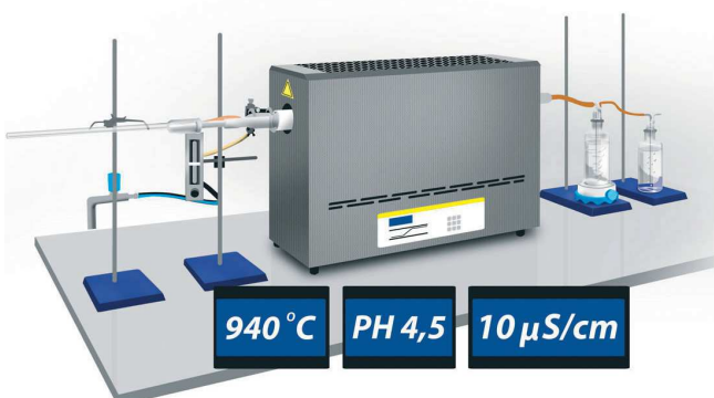
Messung der Korrosivität der Brandgase
