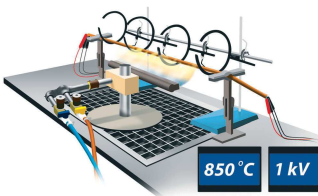
Prüfung gemäß EN 60331 (850°C 1kV)
