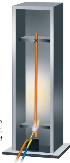
Prüfung der senkrechten Flammenausbreitung, selbstverlöschend
