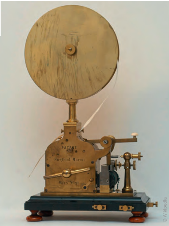
Der Siegeszug schreibender Telegrafen begann mit der Entwicklung geeigneter Kabel. Telegrafen-Reliefschreiber von Siegfried Marcus, Wien, 1861
