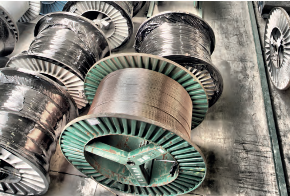
Kablo Hostivař spezialisierte sich auf die Produktion von Aluminiumkabel bis 240 mm² Querschnitt, später sogar in armierten Varianten.
